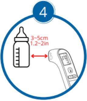
Pointez le thermomètre à 3-5cm de l'object et appuyez sur .
